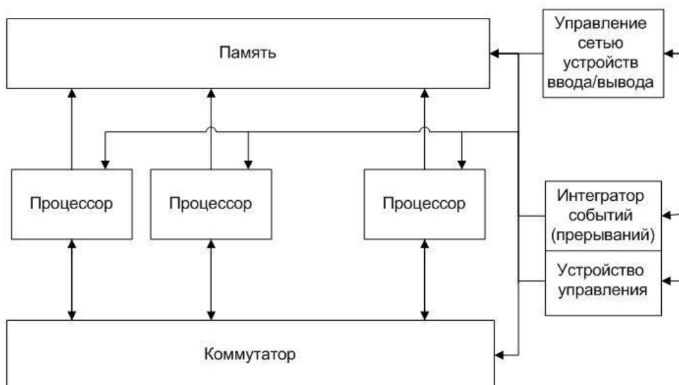
Рис. 30. Многопроцессорная архитектура с общей памятью и централизованным управлением.
