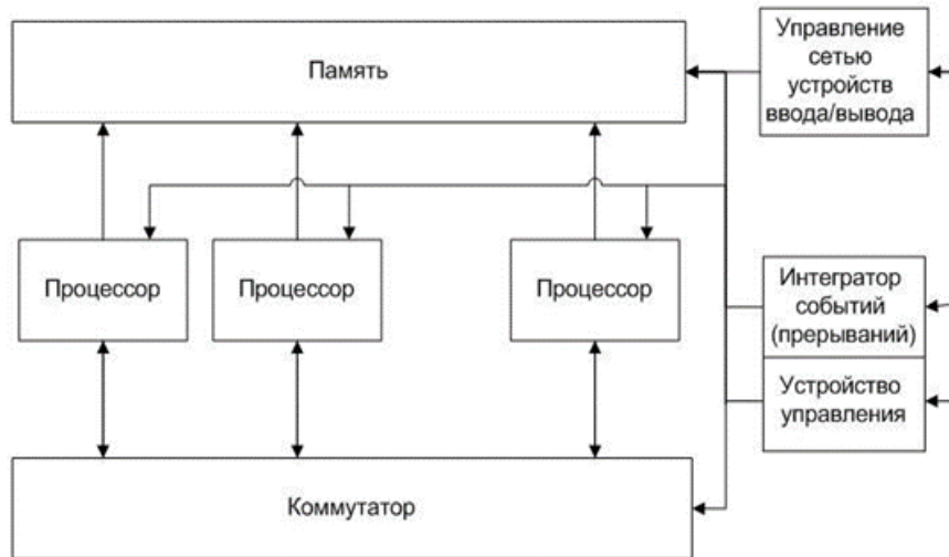
Նկար 32. Ընդհանուր հիշողությամբ ճարտարապետություններ
