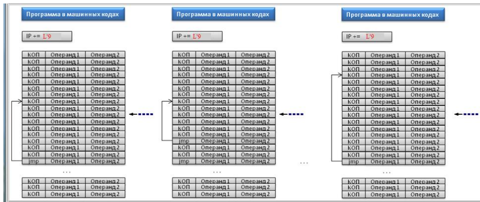
Նկար 8. Մեքենայական կոդերում հրամանների և ընդհատումների մշակում:
