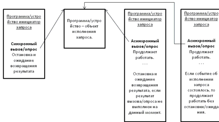
Նկար 7. Մինիստրոն և ասինիստրոն կանչեր:
