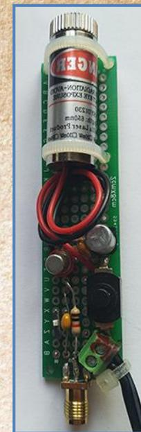
Рис. 5. Лазерный п/п излучатель.
